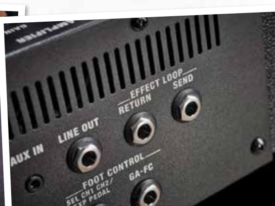
DANKZIJ DE INGEBOWUDE EFFECTSLOOP KUN JE DE EFFECT-EN VAN DE KATANA AANVULLEN MET JE EIGEN PEDALEN
